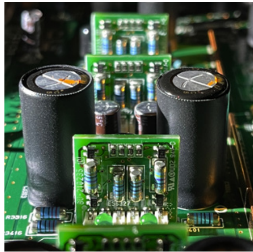
Diskretes Hyper-Dynamic Amplifier-Modul (HDAM)
