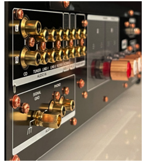
Anschlussfeld mit besonders hochwertigen Buchsen für CD und Phono.
